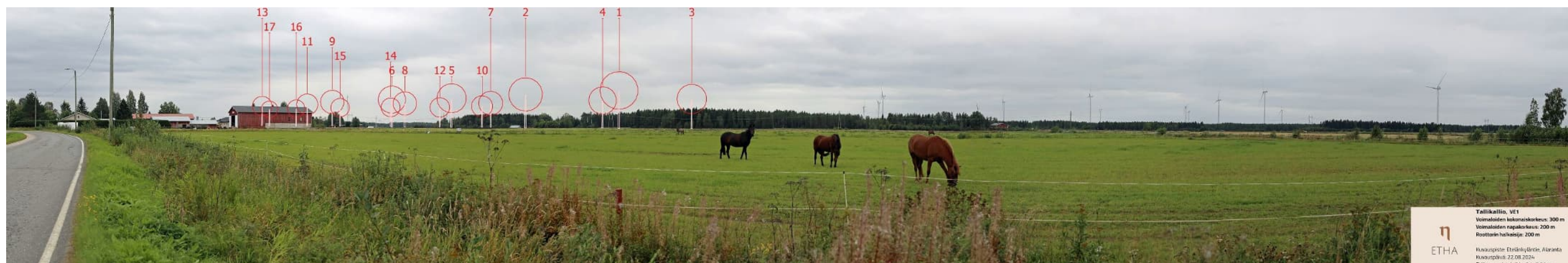
Kuva 2-32. Havainnekuva Etelänkyläntieltä. Valokuvan päälle on kuvattu voimaloiden tornit valkoisella ja larojen pyörimisalue punaisilla ympyröillä. Kaikki vaihtoehdon VE1 seitsemäntoista voimalaa on osoitettu ja numeroitu.
