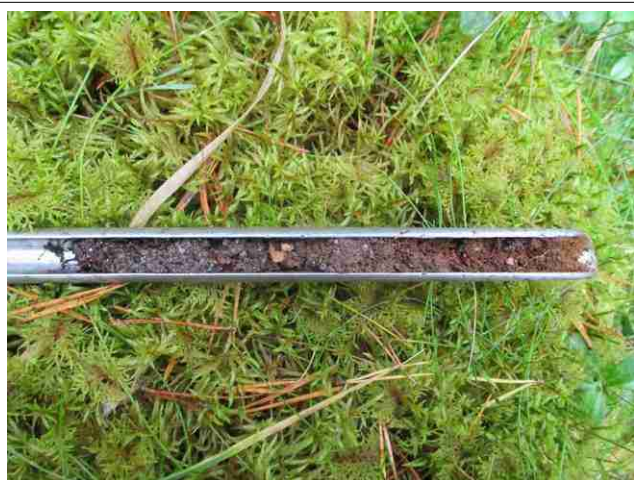
Kairausnäyte alakohteesta 8-2: n. 5 cm tummanharmaan huuhtoutumiskerroksen alla n. 5 cm tummanruskeaa ja n. 4 cm punertavaa likamaata.
